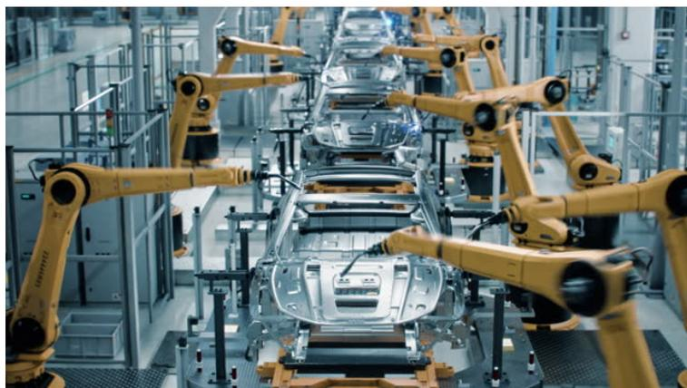
FIGURE 1 – Chaîne de montage de bras de robot automatisé
